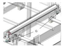
FIGURE 4: TABLE ROLLER ADJUSTMENT
