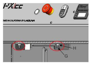
FIGURE 21: OUTFEED ROLLER ADJUSTMENT
