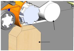
FIGURE 20: OUTFEED ROLLER ADJUSTMENT
