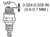
Figure 29. Spark Plug Gap
